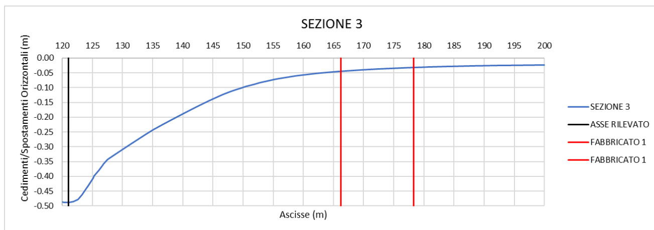
Figura 76 – EDIFICIO 1 – distribuzione dei cedimenti – Sezione 3
