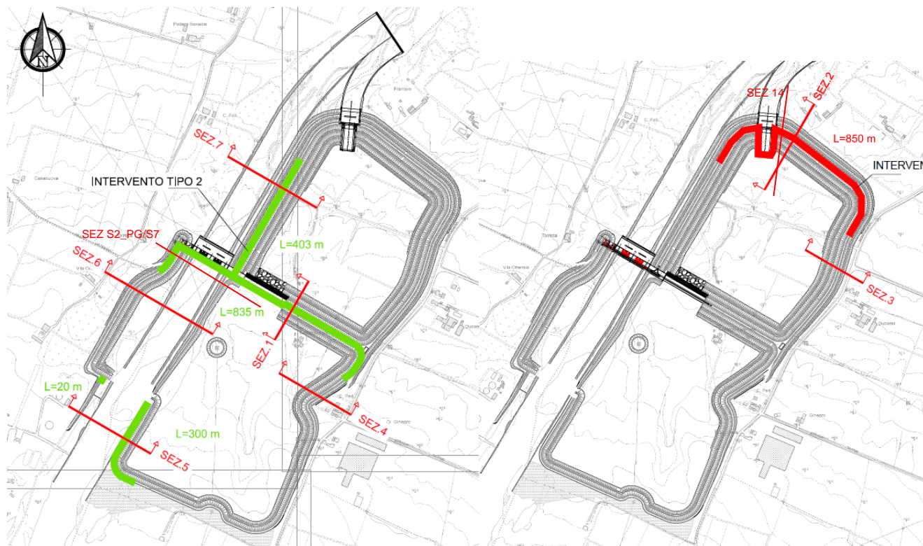
Figura 10 – Sezioni di calcolo e tratti in jet-grouting
